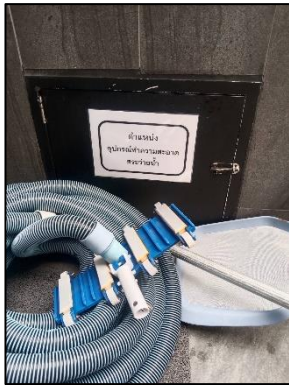
รูปที่ 3-23 ดูแลบำรุงรักษาเครื่องกรองน้ำ และดำเนินการดูดตะกอน ล้างตะไคร่ และตัดเศษผง ของสระว่ายน้ำ
